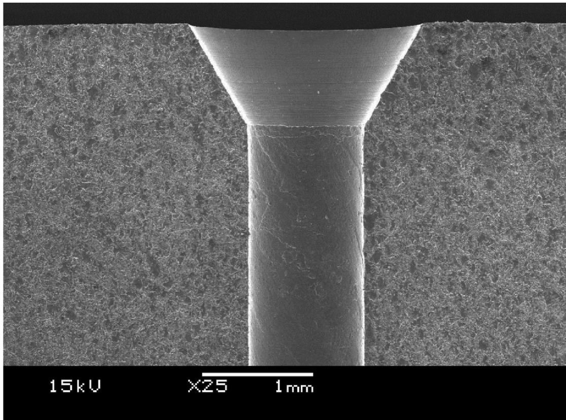
微孔噴嘴鑽削之孔內壁表面
