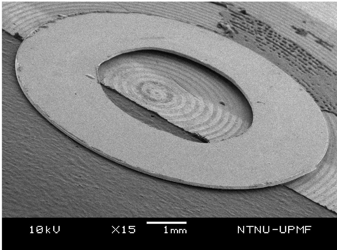
厚度 10  $\mu\text{m}$  鑽石刀具
