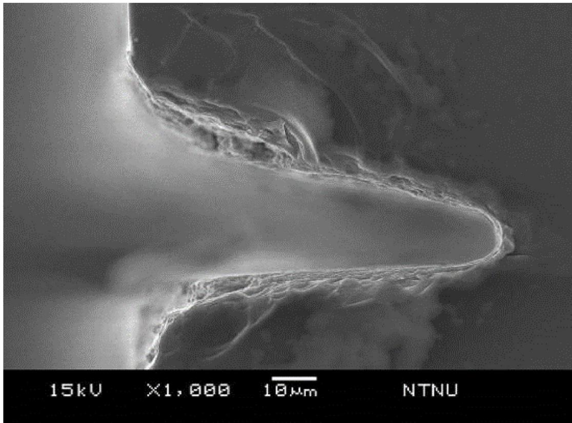
光學玻璃研削微溝槽
