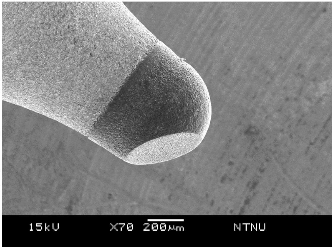
含硼聚晶鑽石球型研削刀具
