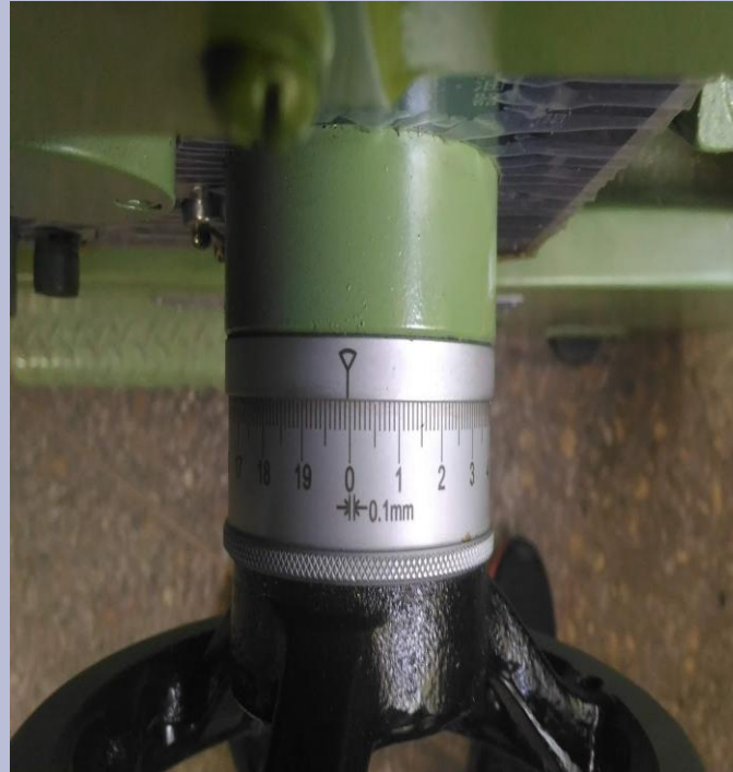
縱向進刀手輪一格 0.1\text{mm} ，一 圈 20\text{mm}
