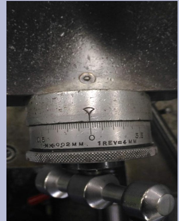
複式刀座手輪一格 0.02\text{mm} ， 一圈 4\text{mm}
