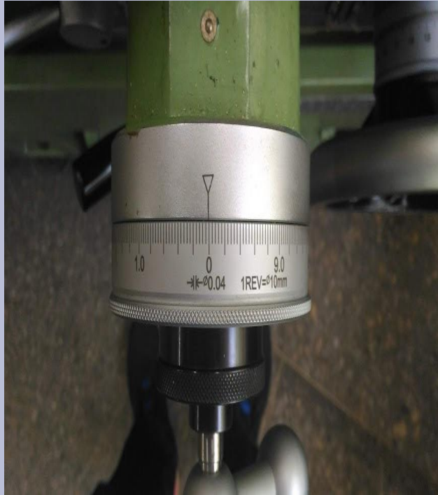
橫向進刀手輪一格 \phi 0.04\text{mm} ， 一圈 \phi 10\text{mm}
