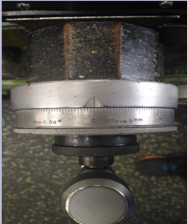
橫向進刀手輪一格 \phi 0.04\text{mm} ， 一圈 \phi 8\text{mm}
