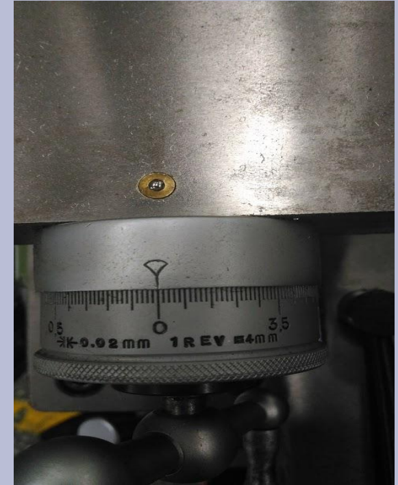
複式刀座手輪一格 0.02\text{mm} ， 一圈 4\text{mm}
