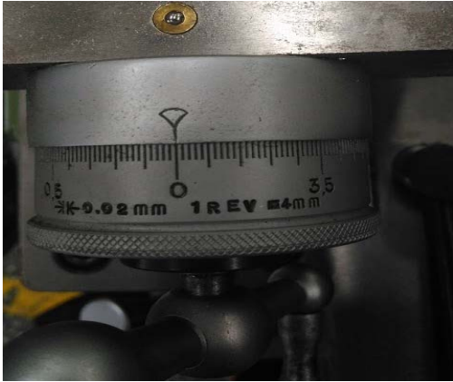
複式刀座手輪一格0.02mm · 一圈4mm
