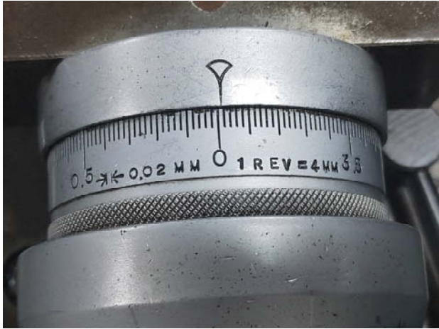
複式刀座手輪一格0.02mm· 一圈4mm
