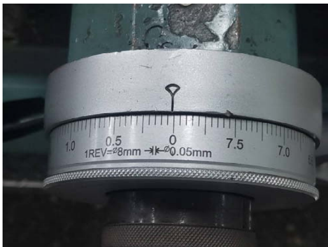
橫向進刀手輪 一格 \phi 0.05\text{mm} 一圈 \phi 8\text{mm}
