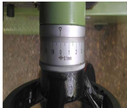
縱向進刀手輪 一格0.1mm 一圈20mm
