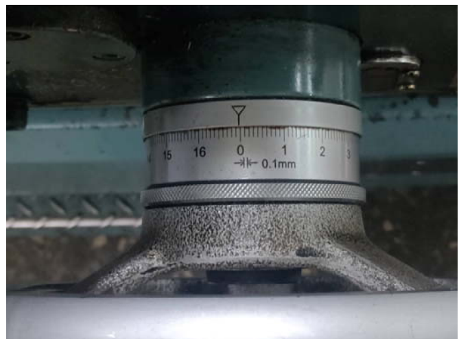
縱向進刀手輪 一格 0.1\text{mm} 一圈 17\text{mm}
