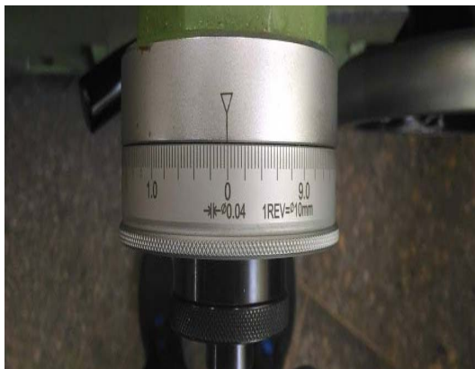
橫向進刀手輪 一格 \phi 0.04mm 一圈 \phi 10mm
