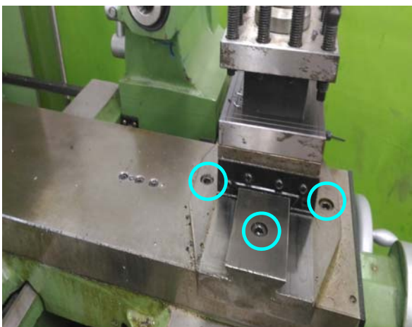
複式刀座調整角度需鬆開3顆螺絲
