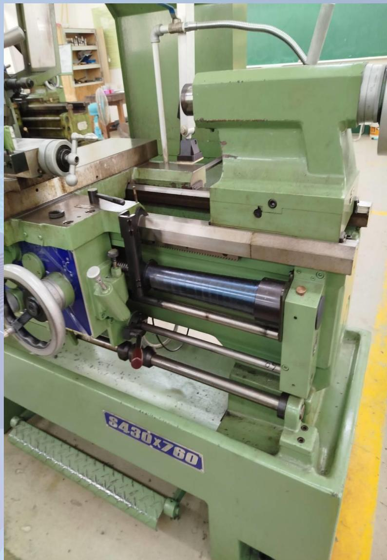
導螺桿護照拆除
